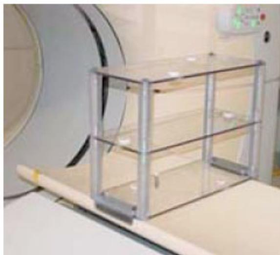
Figura 5.6 Supporto di calibrazione per l'allineamento delle immagini
